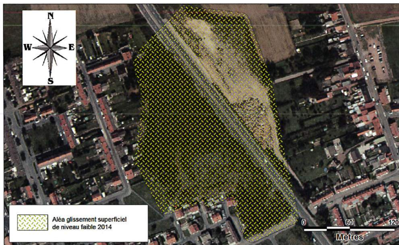
Figure 14 : Nouvelle cartographie (2014) de l'aléa glissement superficiel de niveau faible sur le terril 71
