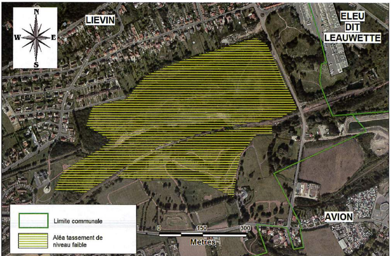
Figure 29 : Cartographie 2014 de l'aléa tassement de niveau faible sur le terril 80
