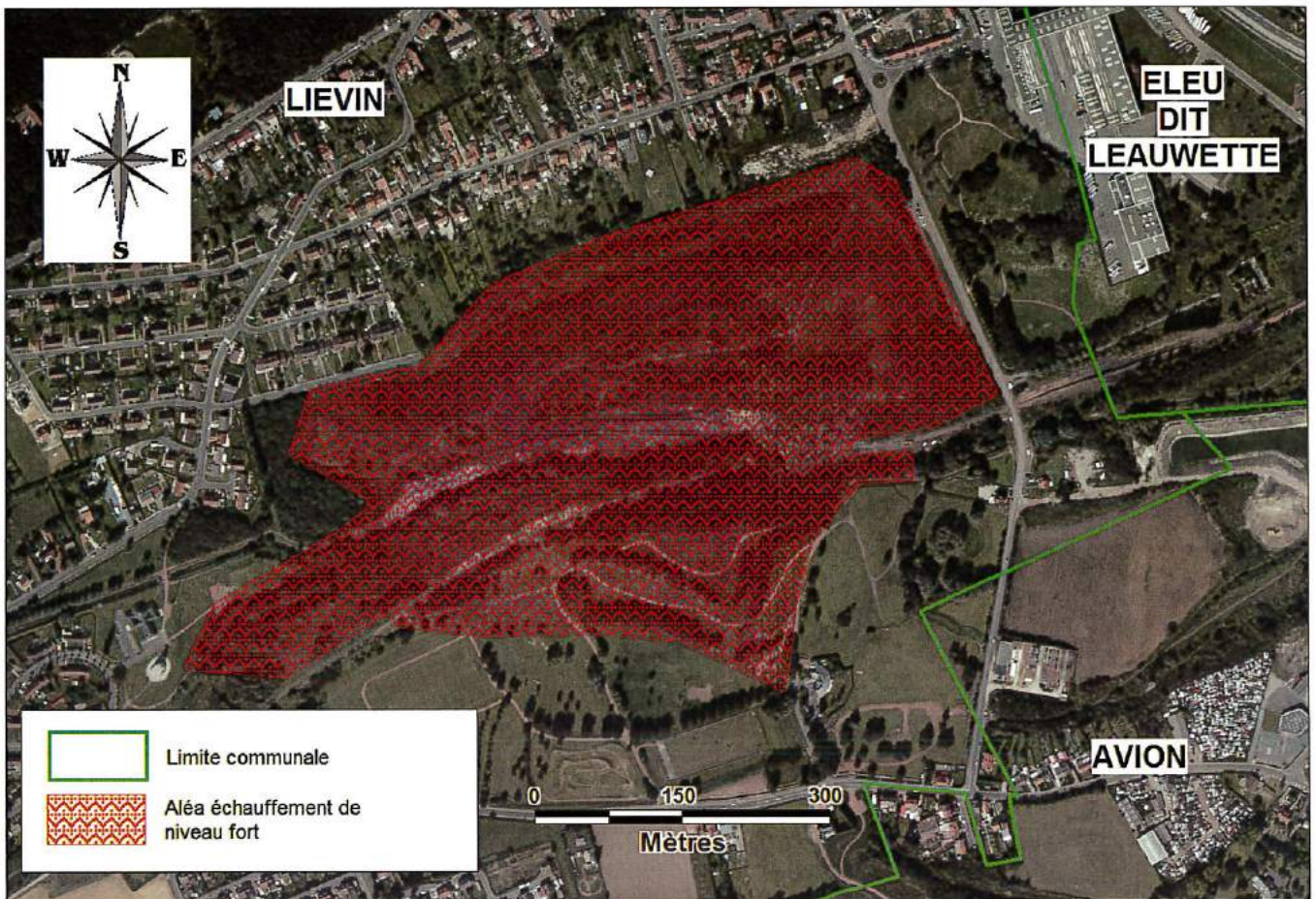
Figure 31 : Cartographie 2014 de l'aléa échauffement de niveau fort sur le terril 80
