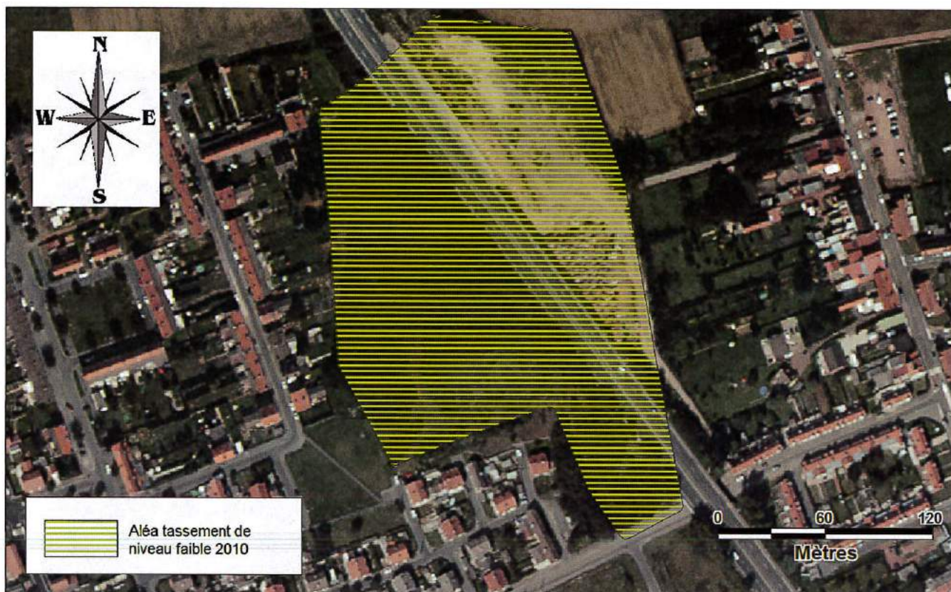
Figure 11 : Ancienne cartographie (2010) de l'aléa tassement de niveau faible sur le terril 71
