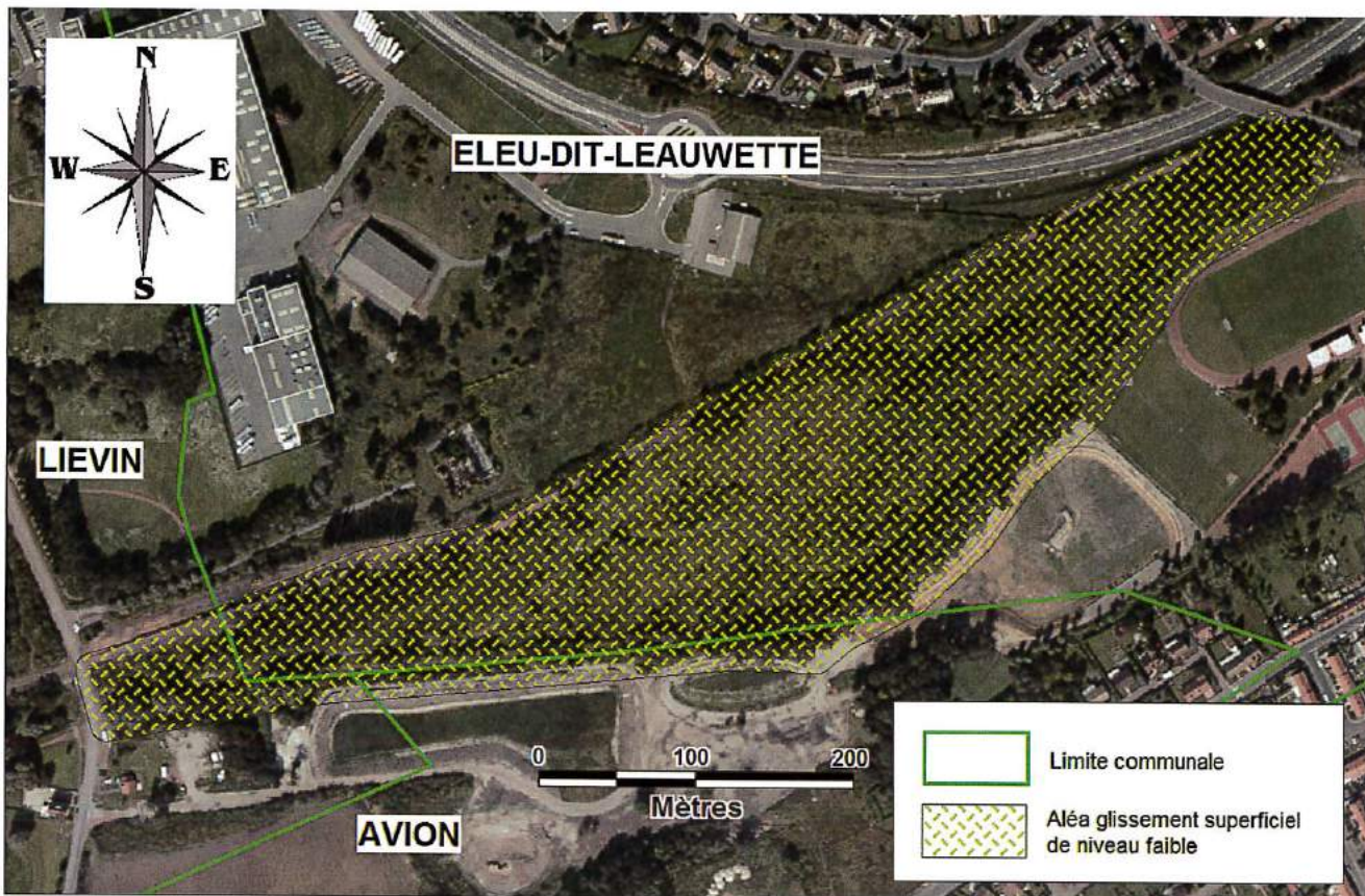
Figure 36 : Cartographie 2014 de l'aléa glissement superficiel de niveau faible sur le terriil 80A
