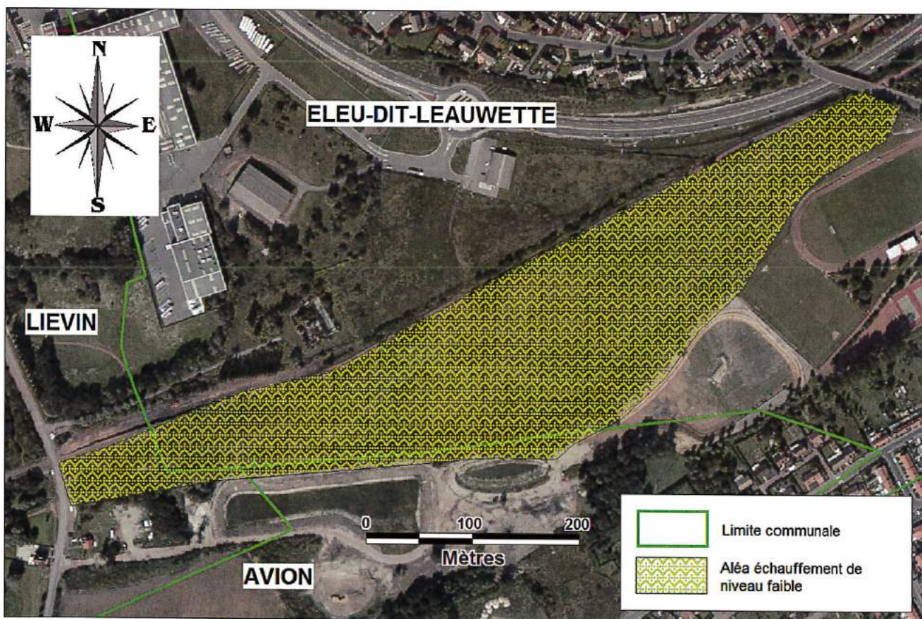
Figure 37 : Cartographie 2014 de l'aléa échauffement de niveau faible sur le terriil 80A
