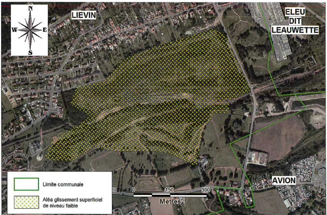
Figure 30 : Cartographie 2014 de l'aléa glissement superficiel de niveau faible sur le terril 80
